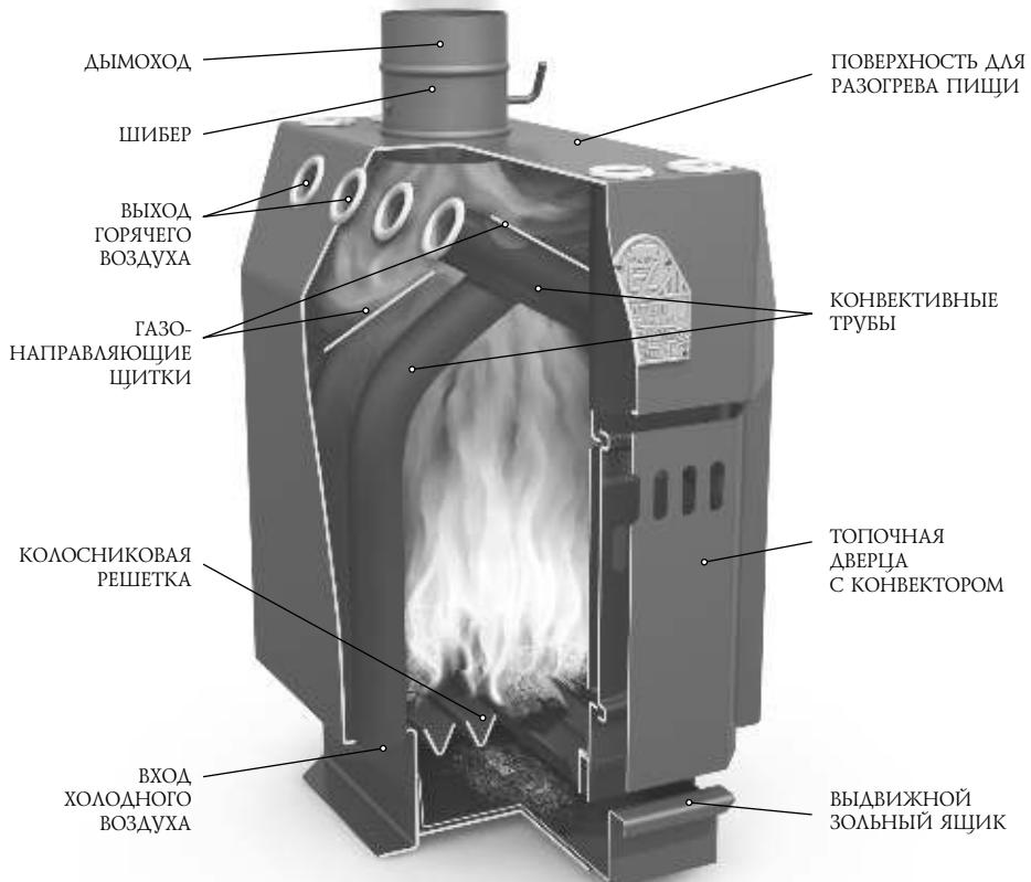
(снизу вверх). На перекрещивающихся вверху конвективных трубах установлены нижние и верхние газонаправляющие щитки, образующие систему газоходов. Дверь топочной камеры, вращаясь на шарнирах, открывается на  $120^\circ$  и имеет полость с установленным в ней уплотнителем. Механизм запирания надежно фиксирует дверцу в закрытом положении поворотом ручки. Колосниковая решетка имеет вид желобов и установлена в нижней части топки.
